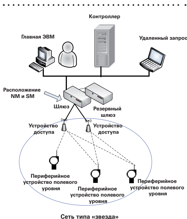
Рисунок 4-2 | Параллельный доступ с множеством подключений с распределенными антенными системами [14]
