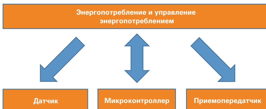
Рисунок 3-3 | Аппаратная структура узла WSN-датчика
