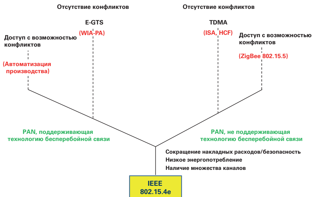
Рисунок A1-1 | Архитектура технологии сетевого доступа IEEE 802.15.4e [59]
