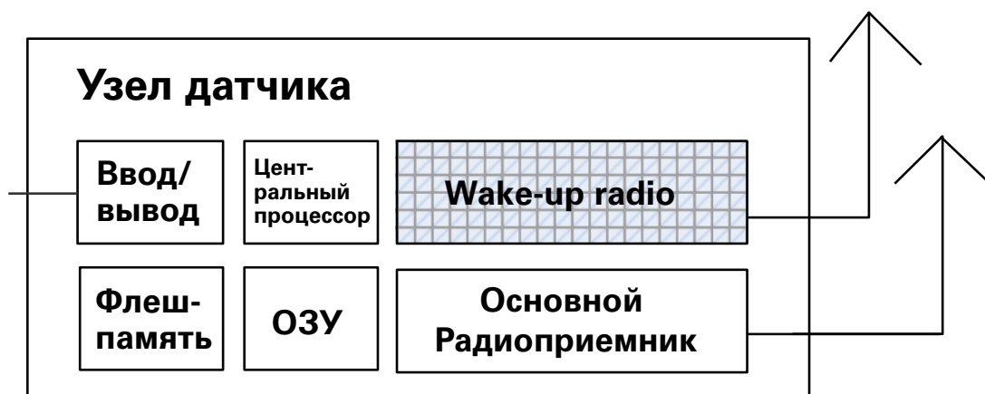
Рисунок 3-14 | Радиоприемник безопасного пробуждения [29]
