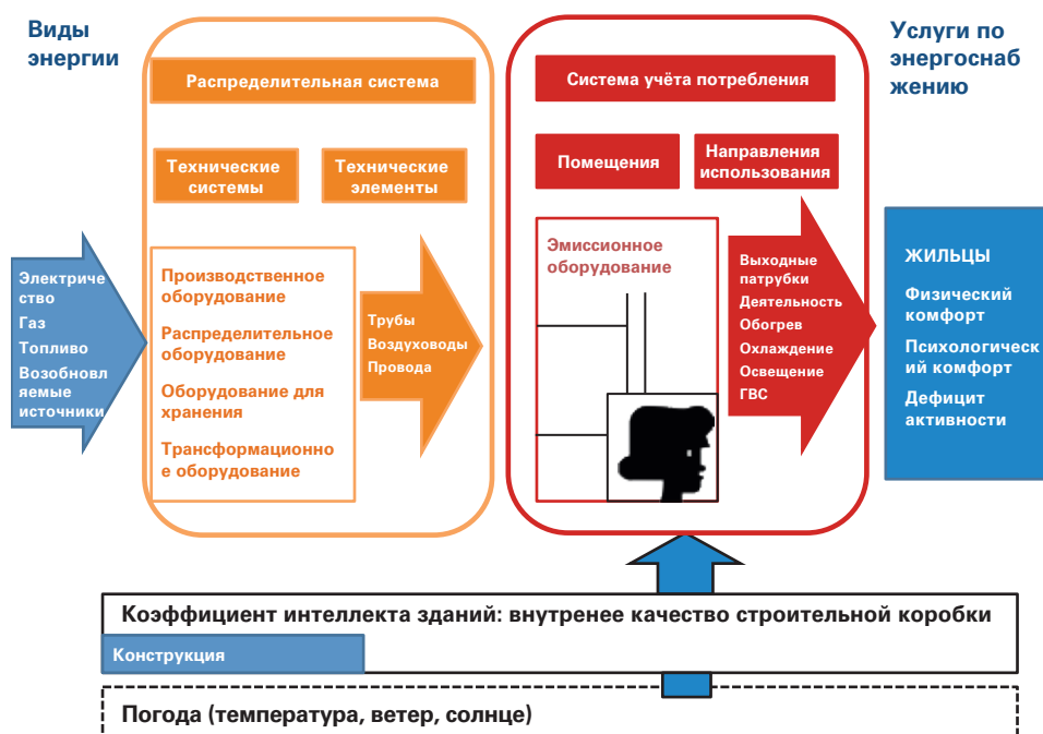
Рисунок 5-10 | Системный подход по обеспечению энергоэффективности зданий
